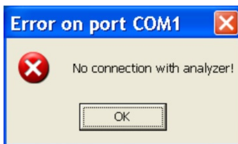
Rysunek 11. Komunikat błędu komunikacji z analizatorem.
